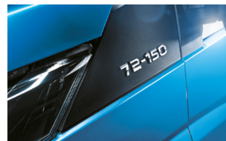
Le système de repérage du Daily est simple et intuitif : les codes établissent le poids total en charge (en quintaux) et la puissance (en ch).
